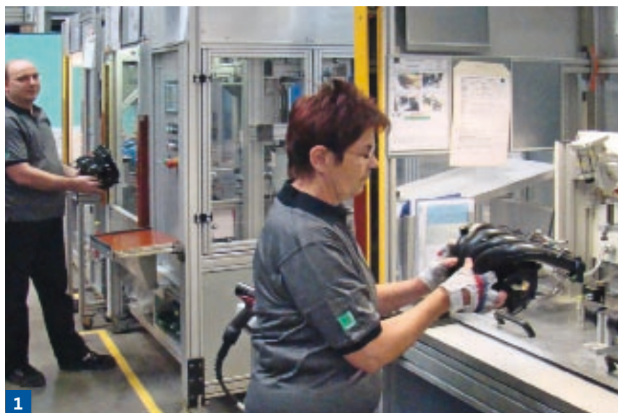
1) Saugrohrproduktion in Sonneberg: Endprüfung auf Funktion und Dichtheit. Der Thüringer Standort wird gerade erweitert. 2) Ingenieure bei der Akustikprüfung im Schallmessraum am Mann+Hummel-Hauptsitz in Ludwigsburg. 3) Luftfiltersystem für den Mercedes-Benz ML 450 Hybrid: bestehend aus Luftfiltergehäuse, Reinluftleitung mit Faltenbalg und Rohluftleitung. Das trapezförmige Luftfilterelement bietet trotz geringer Faltenhöhe eine große Oberfläche.
